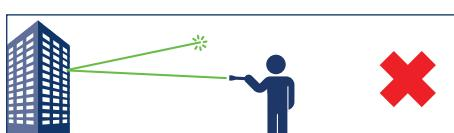
Nunca apunte el dispositivo láser hacia superficies reflectantes como espejos, ventanas y objetos metálicos.
